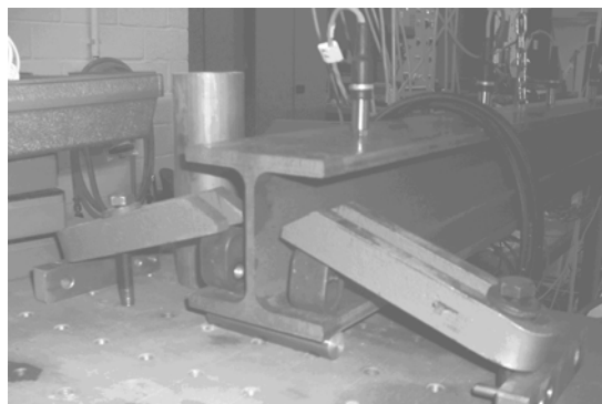
Slika 4. Oslonac - gređa II Figure 4. Support - beam II.
