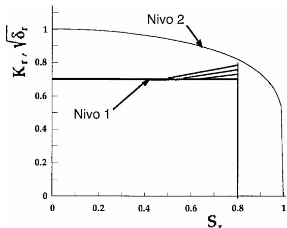
Osim za procenu integriteta konstrukcije, projektna kروا može da se koristi za određivanja kritične dužine prsline ako se zna ukupna deformacija  $\epsilon$ , deformacija pri tečenju  $\epsilon_y$ , i kritična vrednost otvaranja vrha prsline  $\delta_c$ , odnosno za izračunavanje  $\delta_c$  ako se zna dužina prsline  $a$ .
