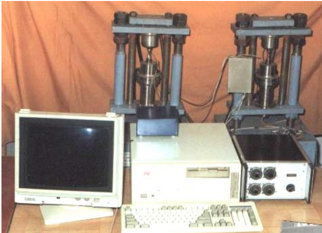
Slika 3. Opšti izgled uređaja za ispitivanje toplotnog zamora ISIM /20/, /21/
