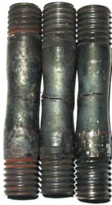
Slika 18. Epruvete polomljene pri ispitivanju toplotnim zamorom
