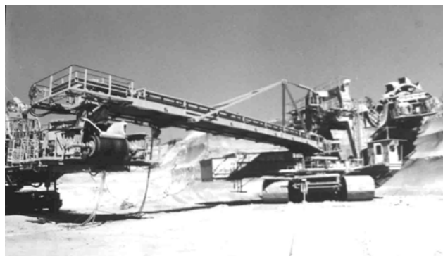
Slika 5. Rekonstrukcija strele Figure 5. Cantilever beam reconstruction.
