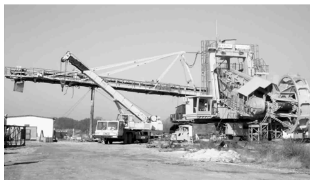
Slika 5. Rekonstrukcija strele Figure 5. Cantilever beam reconstruction.
