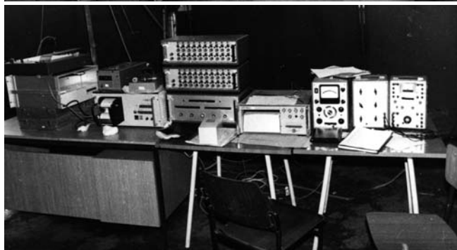
Eksperimentalna postavka za direktno merenje J integrala na IFMASS 2 (Pokajnica 1982)
