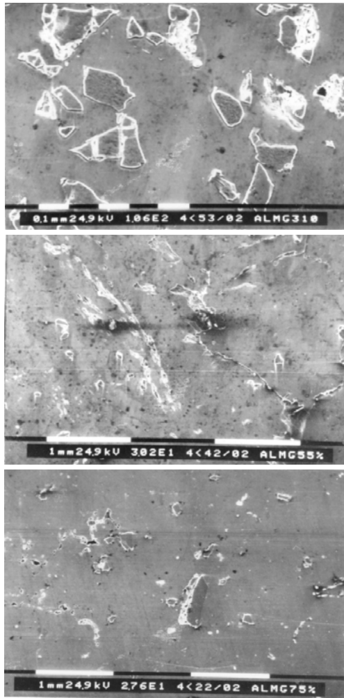
Slika 1. Mikrostruktura metal matičnog kompozita (gore: AlMg3+10%SiC; sredina: AlMg5+5%SiC; dole: AlMg7+5%SiC)
