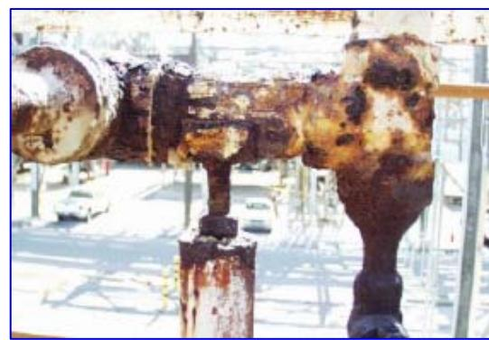
Slika 5. Korozija ispod izolacije, /2/
