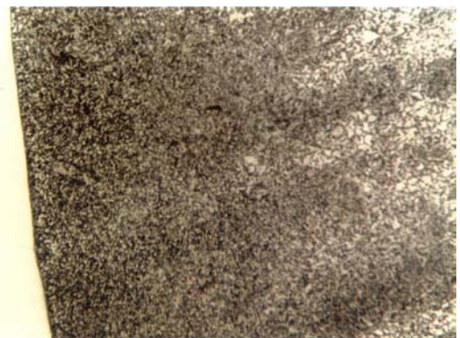
Slika 18. Mikrostruktura ZUT (200x) Figure 18 - HAZ microstructure (200x)
