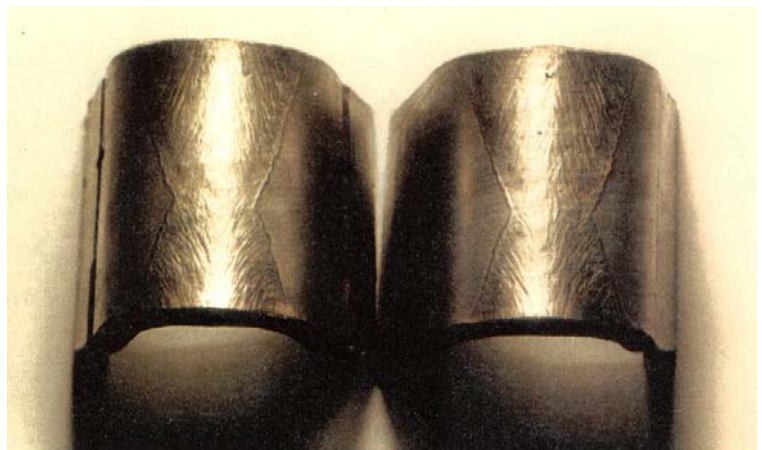
Slika 20. Epruvete za savijanje oko trna Figure 20 - Transverse side bend test specimens
