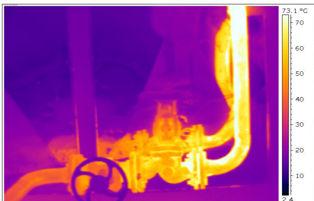
Slika 16. Termogram izolacije kotla sa uočljivom refleksijom (levo) i izgled konstrukcije (desno), /3/ Figure 16. Thermogram of boiler insulation with visible reflection (left) and view of structure (right), /3/.
