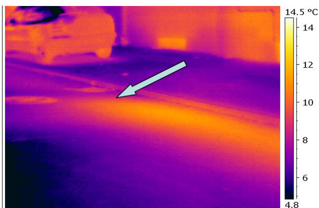
Slika 17. Detekcija curenja ukopanog toplovoda, /3/ Figure 17. Leakage detection of underground pipeline, /3/.
