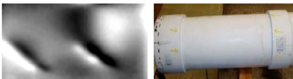
Slika 9. Širogram (levo) dobijen ispitivanjem PVC cevi (desno) pod unutrašnjim pritiskom od 0,02 MPa
