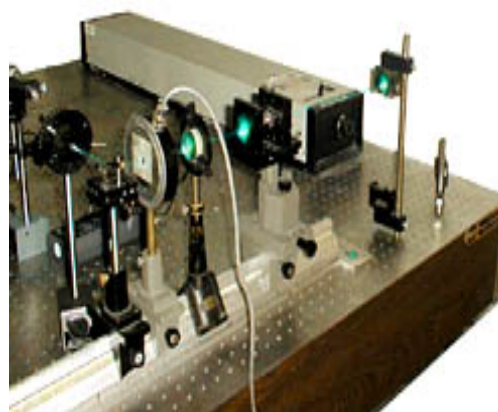
Slika 1. Snimanje i rekonstrukcija holografskog lika (levo) i komponente laboratorijskog holografskog interferometra (desno) Figure 1. Recording and redesign of holographic image (left) and components of laboratory holographic interferometer (right).
