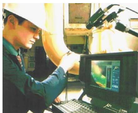
Slika 5. UT kolena cevovoda sa C-prikazom (video kamera) Figure 5. UT of a pipe bend with C-scan (video tracking).
