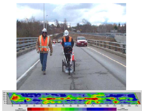
Slika 4. Radarski sistem za ispitivanje ploče mosta sa C-prikazom Figure 4. Radar system for bridge deck inspection with C-scan
