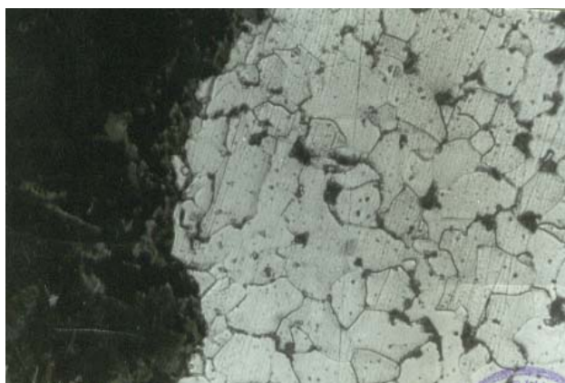
Slika 3. Mikrostruktura uz površinu dimne cevi, \times 125
