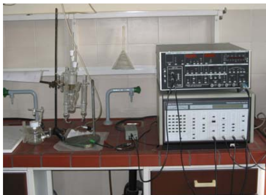
Slika 9. Sistem za elektrohemijska koroziona merenja
