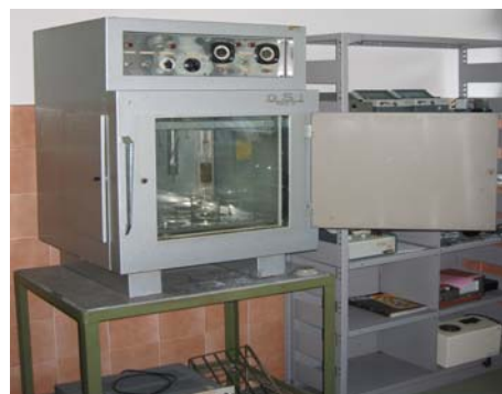
Slika 8. Uređaj za ispitivanje korozije naizmeničnim uranjanjem
