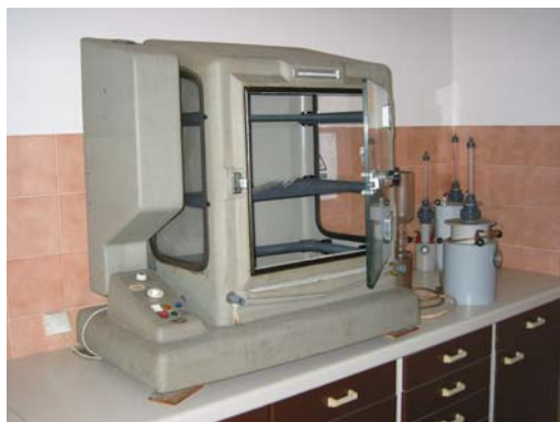
Slika 7. Izgled komore za ispitivanje po metodi \text{SO}_2 i \text{CO}_2
