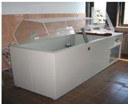
Slika 6. Izgled komore za ispitivanje metodom slane magle
