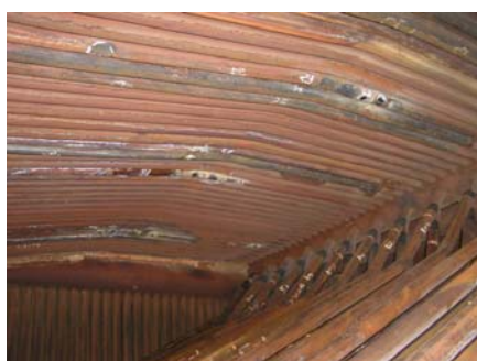
Slika 9. Videoskopski snimak curenja i prevarivanja plafonskih cevi u donjoj zoni, na slici desno se vidi talog formiran sa vodene strane, /6/
