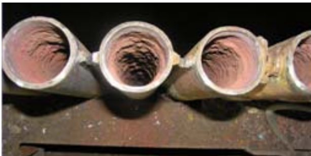
Slika 12. Talog na unutrašnjoj strani ekranskih cevi
