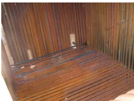
Slika 8. Korozija gornjeg reda cevi ekonomajzera
