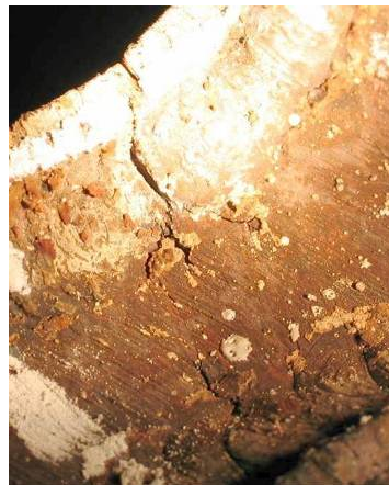
Slika 15. Prsline na cevnoj ploči nastale pod uticajem prekoračenja i promene temperature
