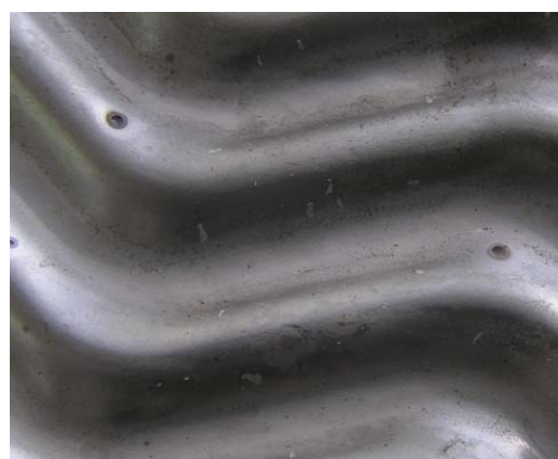
Slika 20. Spoljnji pogled na ploču izmenjivača toplote i vidljive perforacije
