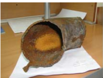
Slika 22. Izgled kolena oštećenog korozijom sa unutrašnje strane (levo), brazde na gornjoj (sredina) i donjoj izvodnici (desno)
