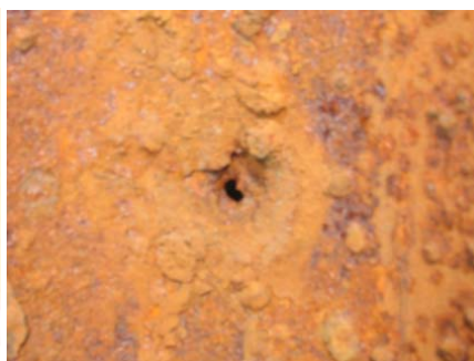
Slika 21. Izgled cevi oštećenih korozijom sa unutrašnje strane (levo), izgled taloga (sredina) i perforacija (desno)
