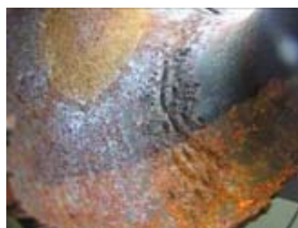
Slika 22. Izgled kolena oštećenog korozijom sa unutrašnje strane (levo), brazde na gornjoj (sredina) i donjoj izvodnici (desno)
