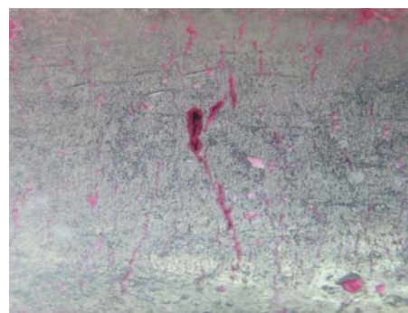
Slika 7. Vlaženje na ekranskim cevima: izgled (levo), orijentacija oštećenja (sredina), slika ispitivanja penetrantima (desno), /6/
