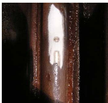
Slika 7. Vlaženje na ekranskim cevima: izgled (levo), orijentacija oštećenja (sredina), slika ispitivanja penetrantima (desno), /6/
