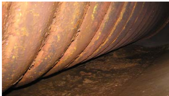
Slika 13. Talog na plamenici
