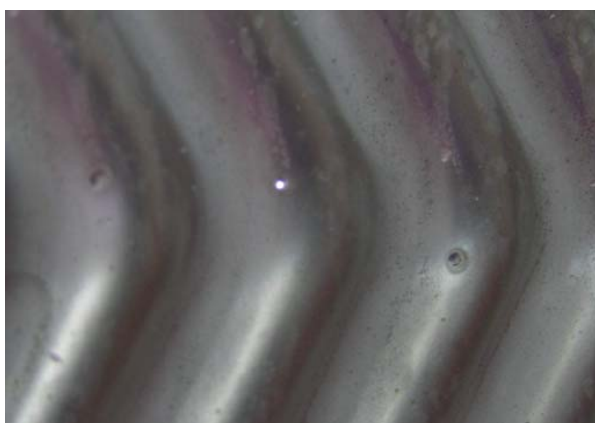
Slika 20. Spoljnji pogled na ploču izmenjivača toplote i vidljive perforacije
