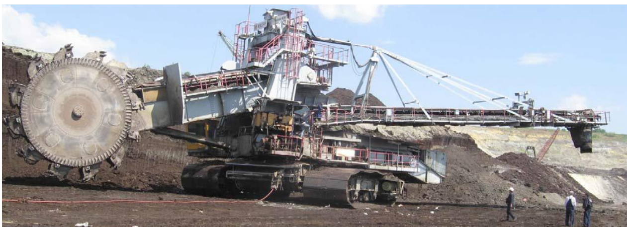
Rotorni bager BWE C700S posle rekonstrukcije sa dodatnim novim zategnutim elementima (štapovima)
