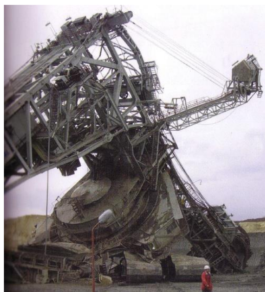
Havarisani rotorni bager
