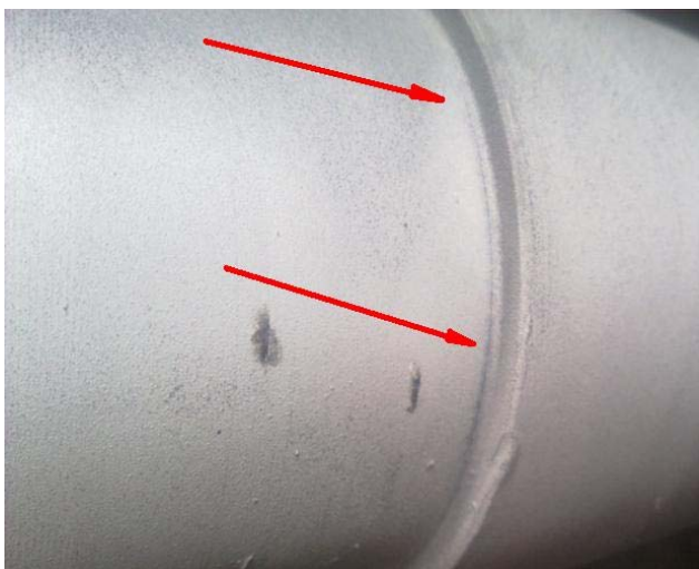
Figure 17. Crack in the maximum stress area. Slika 17. Prslina u oblasti najvećih napona
