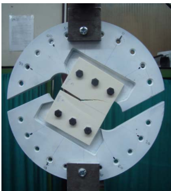
Figure 2. Cracked foam specimen in loading grips. Slika 2. Epruveta sa prslinom u alatu za pritezanje
