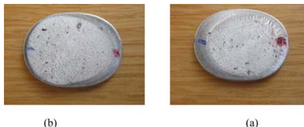
Figure 20. Anisotropic flow where red shows the upper side and blue the lower side of ECAP billet, (a) upper surface of the upsetting specimen, (b) lower surface of the upsetting specimen. Slika 20. Anizotropno tečenje, gde crvena tačka predstavlja gornju stranu a plava donju stranu ECAP uzorka, (a) gornja površina i (b) donja površina deformisane epruvete
