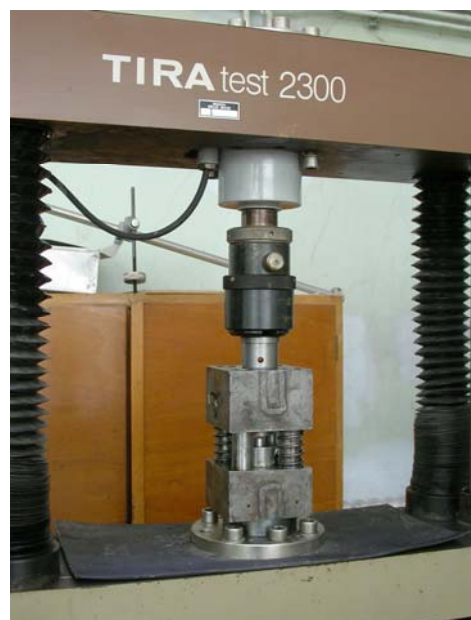
Figure 8. Upsetting machine with the die set. Slika 8. Mašina za ispitivanje sa sklopom kalupa
