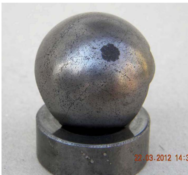
Figure 3. The valve (ball and seat) of piston pump for oil extraction. Slika 3. Ventil (kuglica i sedište) pumpe za izvlačenje nafte
