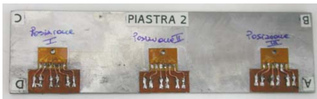
Figure 5. Specimen with rosette strain gauges for the HDM. Slika 5. Uzorak sa mernim rozetama za HDM
