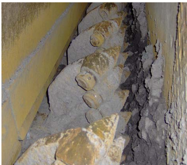
Figure 7. The chain excavator where there are deposits of particles that favour wear. Slika 7. Lančani bager na mestu naslaga čestica koje izazivaju trošenje
