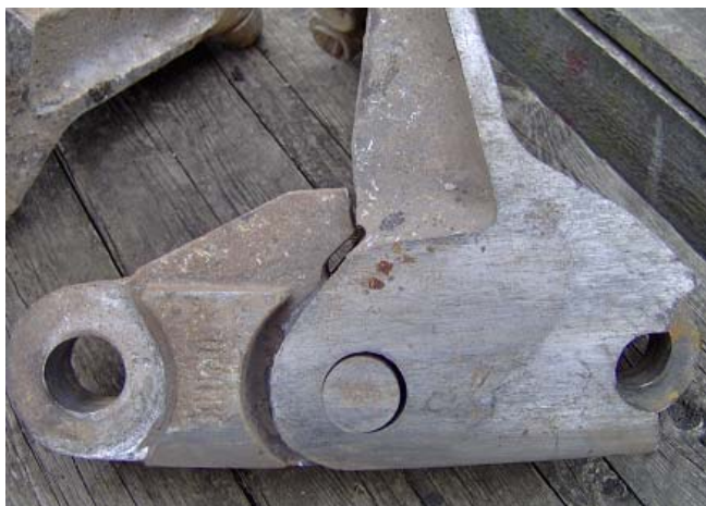
Figure 5. Normal wear of chain elements on contact surfaces (sliding). Slika 5. Normalno trošenje elemenata lanca, na dodirnim površinama (klizanjem)
