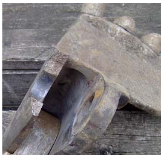
Figure 10. Fracture of chain elements (scraper shovel). Slika 10. Lom elemenata lanca (kašika strugača)
