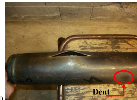
(d) Vessel 4: Dent depth \approx 8.9 mm ( \approx 10\% D_e ); Burst pres. = 30.8 MPa
