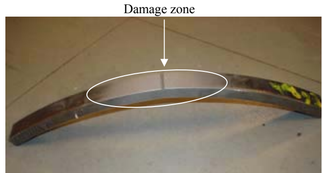
Figure 8. Fatigue specimen geometry: “Roman tile” specimen. Slika 8. Geometrija epruvete za zamiranje: epruveta tipa „rimska ploča“
