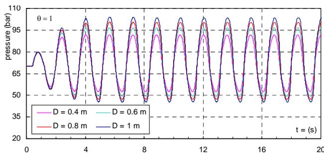
Figure 7. Pressure evolution for different pipe diameter at downstream end of pipe and for hydrogen mass fraction  $\theta = 1$ . Slika 7. Razvoj pritiska za različite prečnike cevi na nizvodnom delu cevi za maseni udeo vodonika  $\theta = 1$ .
