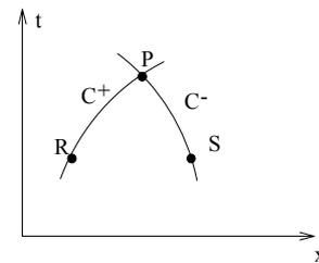
Figure 1. Characteristics lines. Slika 1. Karakteristične krive.
