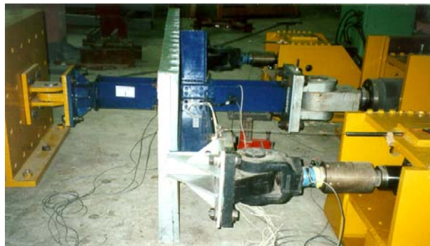
Figure 6. Specimen SP1, in a system for quasi-static loading. Slika 6. Uzorak SP1, u sistemu kvazistatičkog opterećenja
