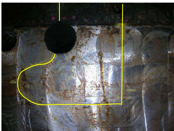
Figure 2. Crack on cylinder surface Slika 2. Izgled prsline na površini cilindra
