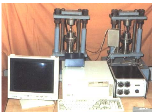
Figure 2. The thermal fatigue testing ISIM's installation. Slika 2. ISIM instalacija za ispitivanje termičkog zamora.
