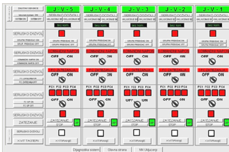
Slika 5. Daljinska kontrola uključivanja frekventnih pretvarača i nisko-naponskih potrošača – zajednička strana za sve transportere u sistemu Figure 5. Remote control for switching on frequency converters and low voltage consumers – common display for all transporters in the system.
