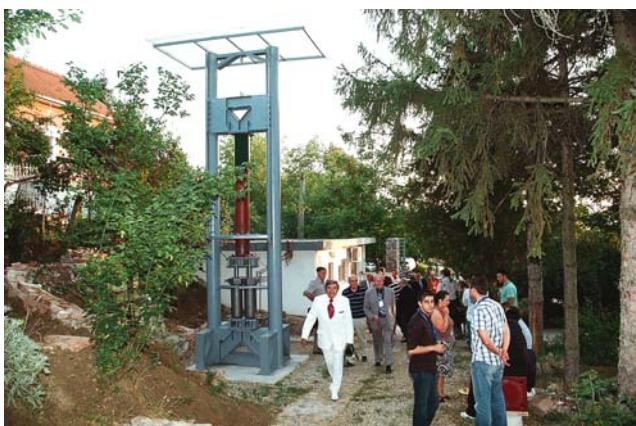
Ispitivanje kvazidinamičkim opterećenjem „Vokzal“ dampera, sa
