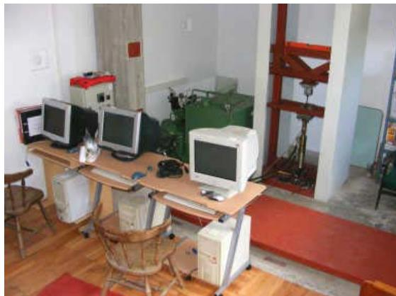
Slika 5. Vibroplatforma u radu
