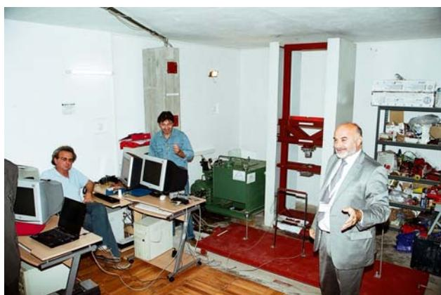
Slika 4. Hidraulična kidalica sa zatvorenom petljom: aksijalna promenljiva sila do  $\pm 20$  kN i pomeranje do  $\pm 30$  mm, ispitni uzorci dužine do 2000 mm, uz frekvenciju do 15 Hz, kombinovana sa vibroplatformom  $800 \times 2400$  mm za modele mase do 1 tone
