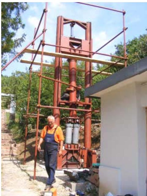
Slika 2. Hidraulična kidalica sa zatvorenom petljom: aksijalna promenljiva sila do  $\pm 5000$  kN i pomeranje do  $\pm 265$  mm, sa vertikalnim okvirom za gabarite do  $5000 \times 3000 \times 1000$  mm, postavljena na otvorenom
