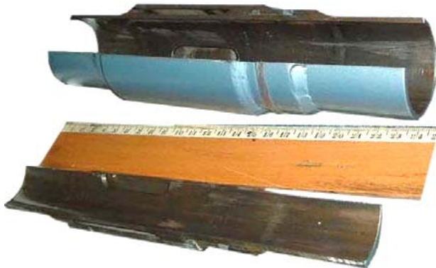
Figure 24. Longitudinal section of damper welded structure. Slika 24. Uzdužni presek zavarene konstrukcije dampera
