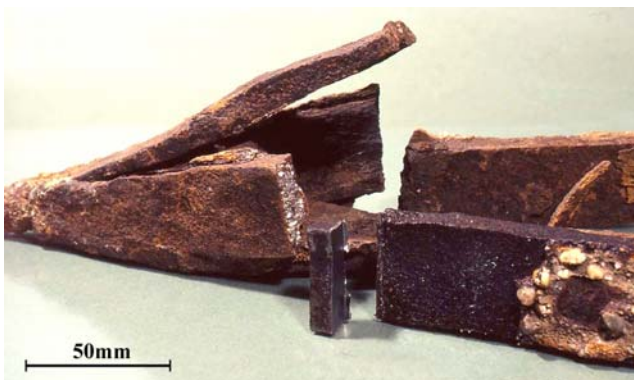
Slika 16. Prelomljena stopa sa odsečenim delom i gornjom prelomljenom površinom nedavnog loma
