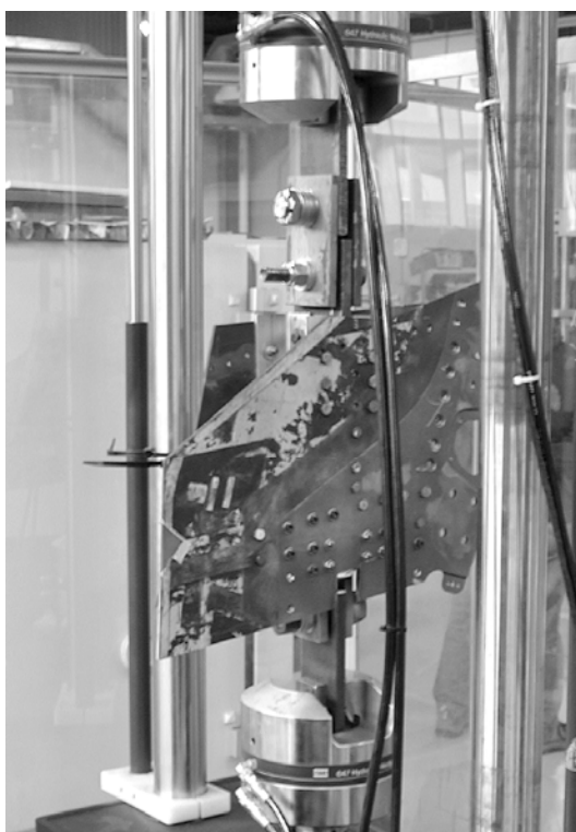
Slika 18. Epruveta druge prekomere (specijale) na 100 kN servo-hidrauličkoj kidalici (levo). Zamorna prsline na zadnjem ligamentu uške. Bele tačke pokazuju ponavljanje blokova (desno gore). Oblik male prsline (desno dole).
