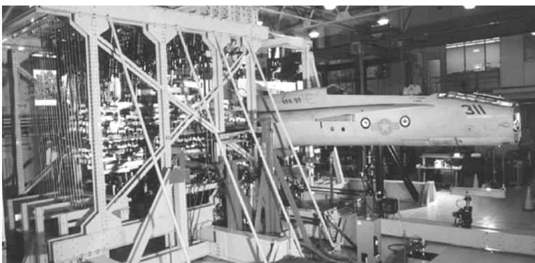
Slika 5. IFOSTP ispitivanje krila (FT245) u Kanadskom nac. savetu za istraž. (NRC) Figure 5. IFOSTP Wing Test (FT245) at Nat. Research Council of Canada (NRC).
