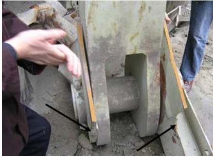
Figure 17. Fracture of two lugs caused the rotor excavator collapse. Slika 17. Lom dve uške izazvao je kolaps rotornog bagera
